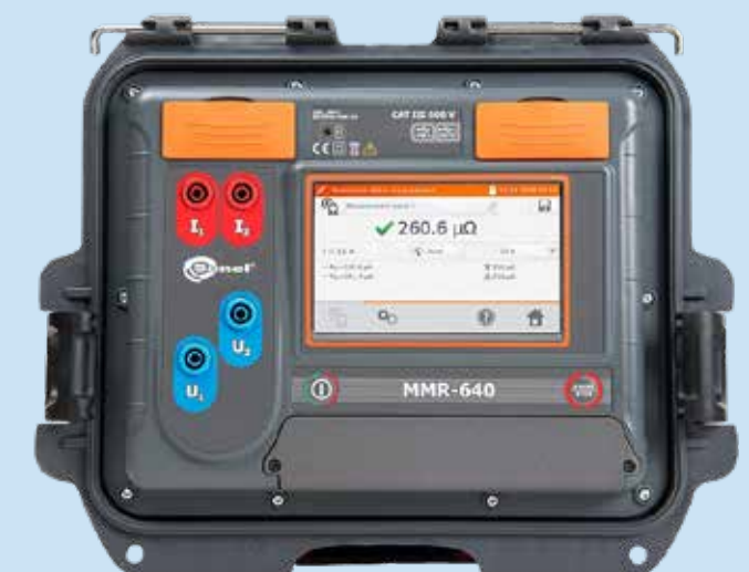
Mikroohmmeter 10A, resistive objekter ELIT MMR-640 Moderne grensesnitt med berøringsskjerm og trådløs kommunikasjon. 0,1μΩ oppløsning. 10A teststrøm. • Robust kapsling med IP67 for bruk i røffe miljø med stor tydelig fargeskjerm. • For måling både på f.eks skrudd, pressede eller sveisede koblinger til jording, lynvern m.m. • Komplet i bæreseske med klemmer og prober, samt programvare for dokumentasjon.
