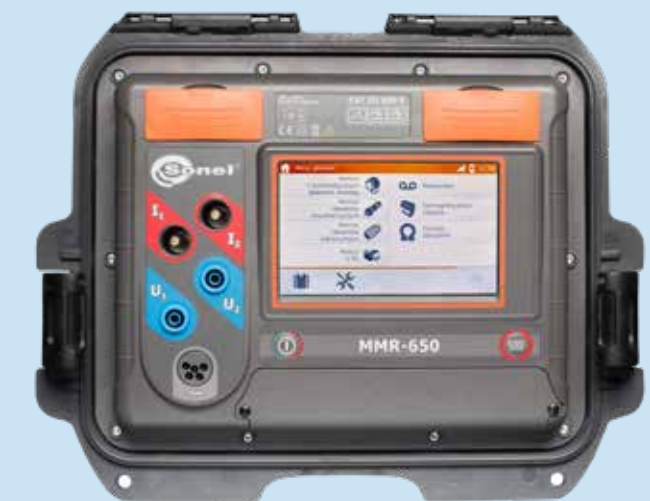
Mikroohmmeter 10A, resistiv/induktiv ELIT MMR-650 Moderne grensesnitt med berøringsskjerm og trådløs kommunikasjon. 10A teststrøm. 0,1μΩ oppløsning. • Tester både induktive og resistive objekter. • Robust kapsling med IP67 for bruk i røffe miljø. • Komplet i bæreseske med klemmer og prober, samt programvare for dokumentasjon.
