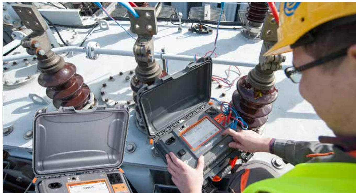
Mikroohmmeter 100A ELIT MMR-6500 Mål HV-brytere og transformatorer med én og samme enhet. 100A teststrøm og 0,1μΩ oppløsning. • Måler resistive objekter med strøm opptil 100 A. • Måler induktive objekter opp til 10 A. • WiFi, USB og LAN kommunikasjon.
