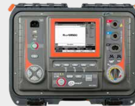
Isolasjonsmåler 5kV, 5mA strøm
